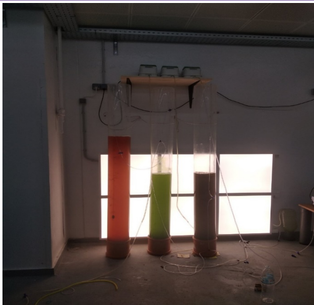
Εικόνα 5: Καλλιέργεια μικροφυκών σε κυλινδρικούς σωλήνες 50 λίτρων
